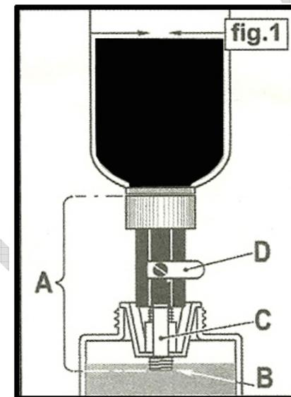
Observe que o reservatório deve estar ajustado na altura A no nível B (neste modelo estamos utilizando o suporte plástico)
