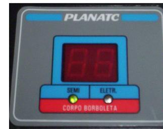
No modo Semi-eletrônico ou eletrônico o teste será efetuado pelo **Boby-GII/7C** em aproximadamente 2 minutos, sendo que o teste avalia as P1, P2 e o reverso, no corpo semi-eletrônico temos que no final do teste avançar manualmente o corpo (simulando o cabo do acelerador) para finalizar o teste, é necessário que o avanço seja linear e contínuo e que esteja atento nos valores mostrados.
