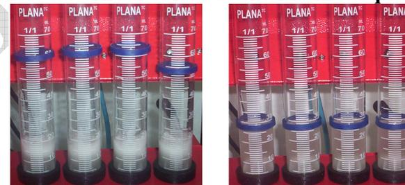
**IMPORTANTE:** - Caso necessite ajuste a pressão (item 6-III). Após o sistema estar pressurizado, os injetores começam a pulverizar, mesmo no meio do teste podemos alterar a pressão.
