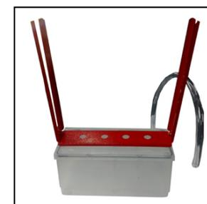
O sistema de descarbonização é um equipamento opcional, que conectado a LB (efetua a pulsação dos bicos em rotações elevadas), efetua a descarbonização dos bicos injetores.
