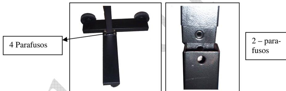
b) Encaixe as duas partes da haste e parafuse-os.
