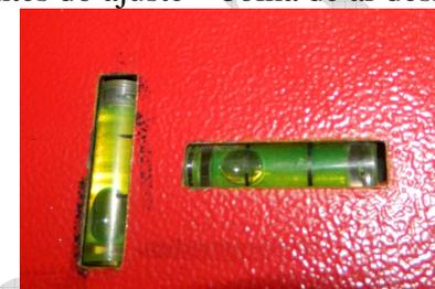
Ajuste Dentro (após o ajuste mencionado acima – bolha de ar nivelado, no centro)
