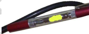
**Atenção: I – A intensidade da lâmpada forte: O cabo de vela está com fuga de corrente.**
