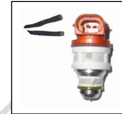
Cabo monoponto a ser conectado no cabo Multiponto da LB.
