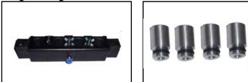
Utilizado para realizar testes de vazão, estanqueidade, equalização e leque de bicos Zetec e Bicos HCMSV.
