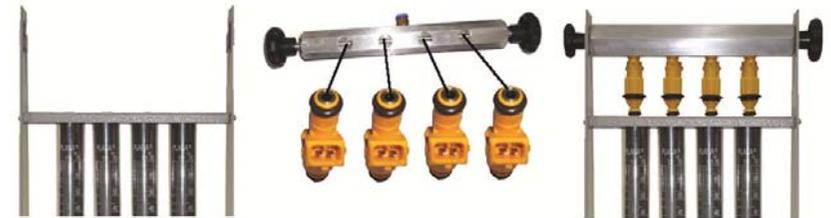
**5 - Montagem do bico injetor monopontos na LB's.**
