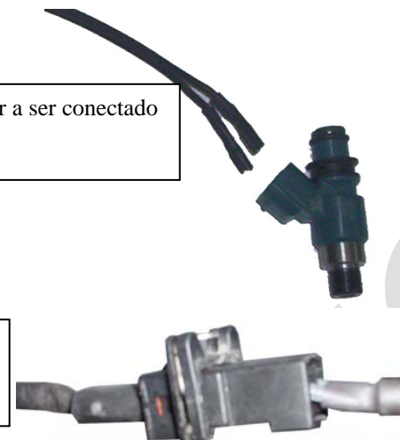
Cabo adaptador x cabo Padrão (LB-Moto).
