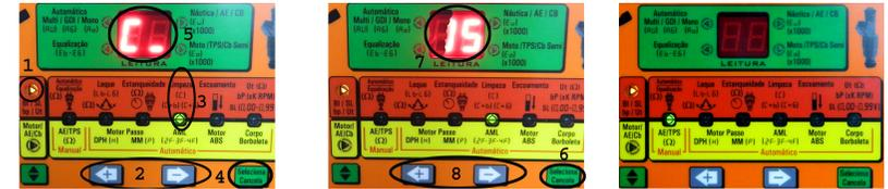
2. Função Cuba + Bico [Padrão ou GDI]: Está função aciona a cuba mais o bico em questão (padrão ou GDI). Após a configuração de tempo (5 a 15 min.) o display irá decrementar o tempo e a cuba ultrasônica acionada e os bicos pulsando.
