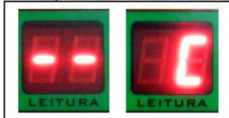
**-Nota:** Os valores lidos de resistência, compare-os com os obtidos com a tabela no final do manual (conforme código do bico tem um valor de resistência), tendo uma tolerância de ~15%, é importante considerar a resistência existente da fiação e de contato, pois os bicos de resistência baixa (GDI) é necessário adicionar + 0,8 Ohms no valor nominal Ex resistência do bico 1,5 + 0,8 do cabo = 2,3 (leitura no display).
