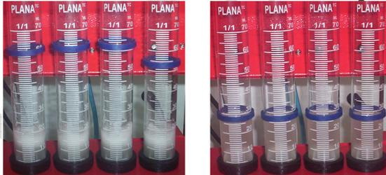
**IMPORTANTE:-** Caso necessite ajuste a pressão (item 6-II). Após o sistema estar pressurizado, os injetores começam a pulverizar, mesmo no meio do teste podemos alterar a pressão.
