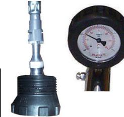
**3– Teste da tampa do reservatório da água. (sistema selado)**
